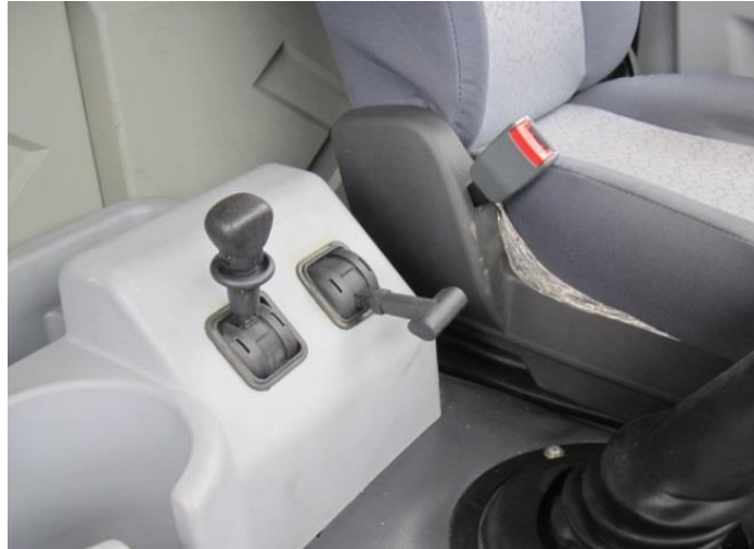
图示手柄落下者为挂车独立制动手阀。
